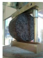
Figura 6 – Ensaio de tração.
