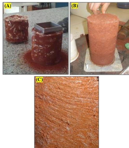
Figura 1: (A) CP moldado com fibras mal abertas; (B) CP moldado com fibras bem abertas; (C) Detalhe da abertura e distribuição das fibras.
