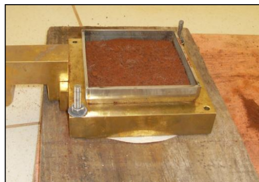
Figura 3: Corpo de prova moldado dentro da célula superior com energia normal do Proctor
