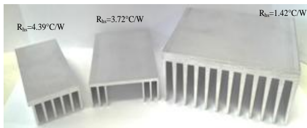
Figura 3. Dissipadores e suas respectivas resistências térmicas
