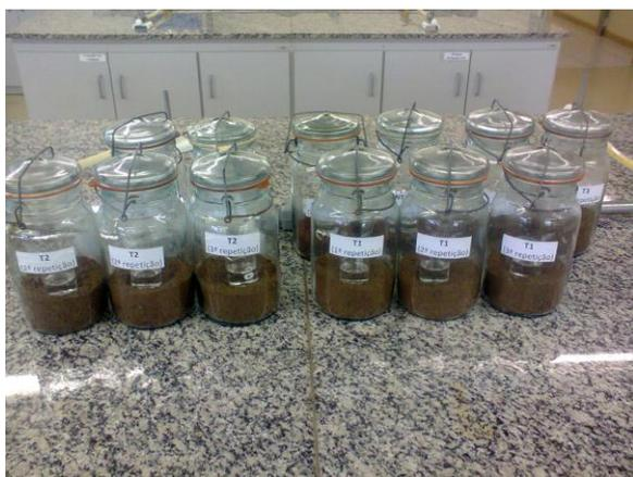
Figura 3. Experimento de evolução de CO<sub>2</sub>.
