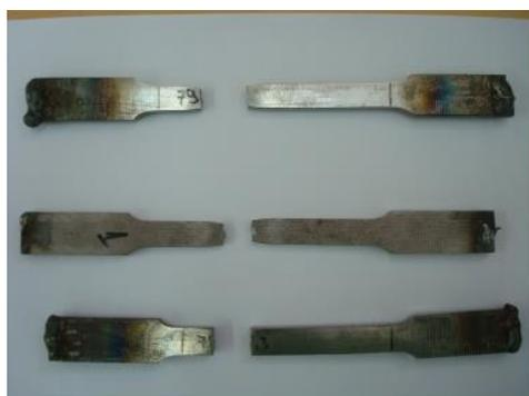
Figura 2 - Corpos de prova de SAE 4140.
