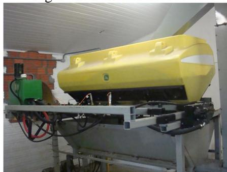
Para a verificação do torque encontrado na transmissão do sistema dosador de fertilizante da plantadeira, foi instrumentado o eixo que aciona o sistema. O eixo foi submetido ao tratamento de superfície com o uso de ácido fosfórico e de uma base de amônia. A partir daí, são colados os Strain Gages, e conectados os fios que fazem a transmissão do sinal elétrico.
