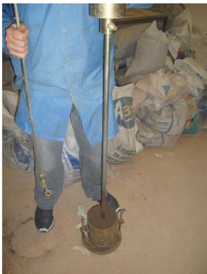
Figura 5: Execução do ensaio de DCP em laboratório
