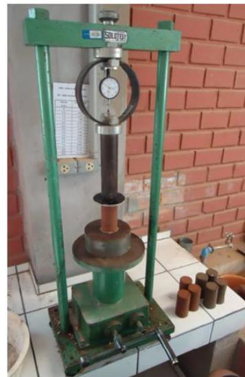
Figura 2 – Ensaio de compressão
