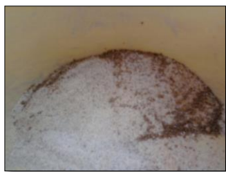
Figura 4. Ágata contaminada com metal desgastado do britador de mandíbulas
