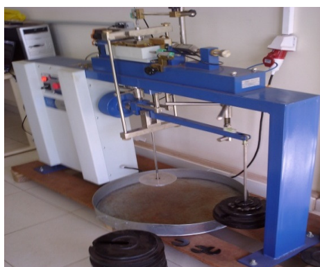
Figura 2. Ensaio de cisalhamento direto em execução.
