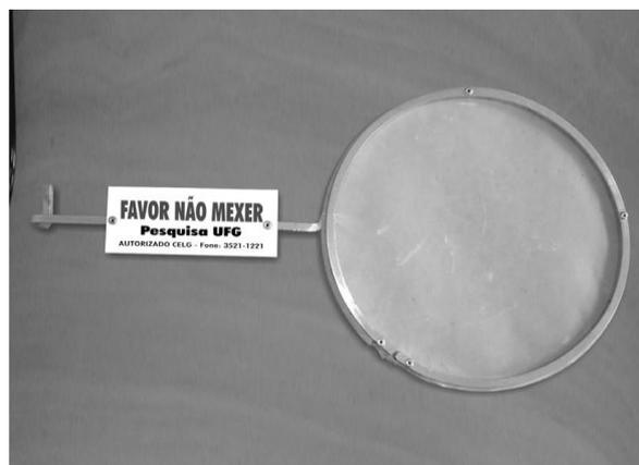
Figura 1. Amostrador passivo para material particulado (Brait).
