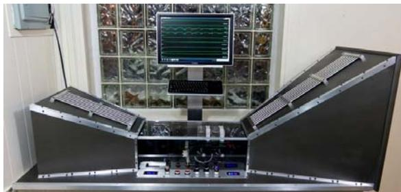
**Figura 2.** Aparato experimental utilizado em pesquisas em controle térmico de eletrônicos.
