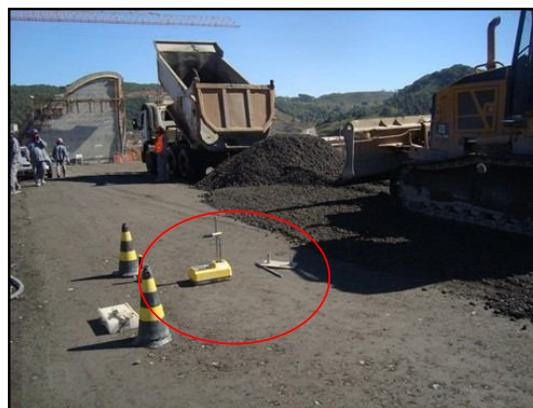
Figura 03 -Densímetro nuclear, concreto recém compactado. Fonte: Autor.
