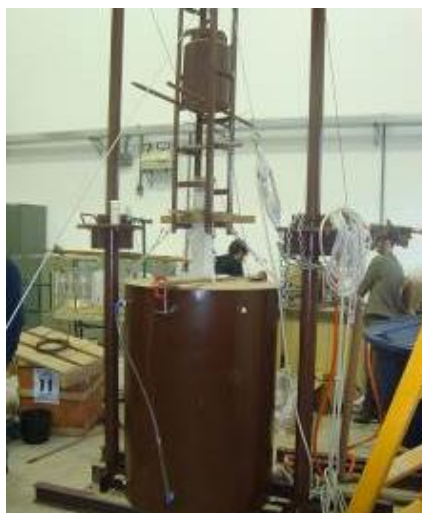
Figura 1: Aparato utilizado para a cravação da estaca
