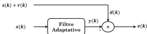
Figura 2. Esquema de filtragem adaptativa.
