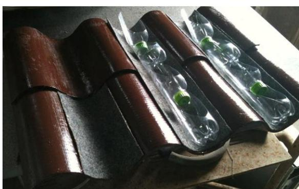
Figura 4 – modelo das telhas com a colagem das garrafas PET.
