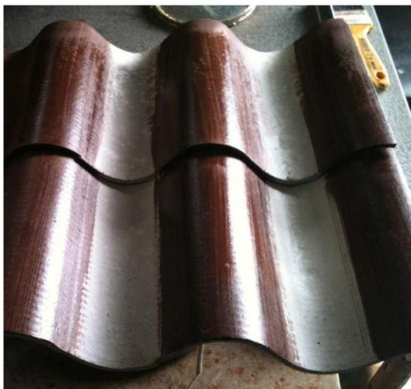
Figura 2 – Telha de fibrocimento com selador.
