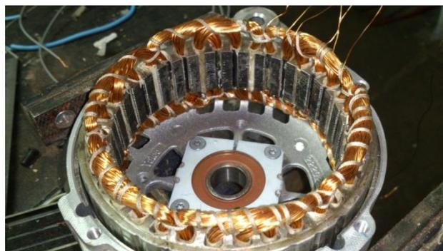
Figura 2. Aspecto final do estator já encaixado na estrutura do gerador.
