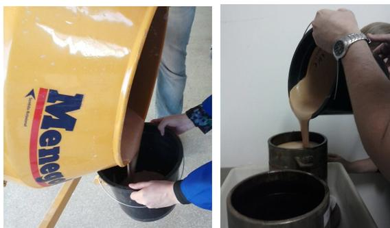
Figura 3. Colocação da mistura nos moldes
