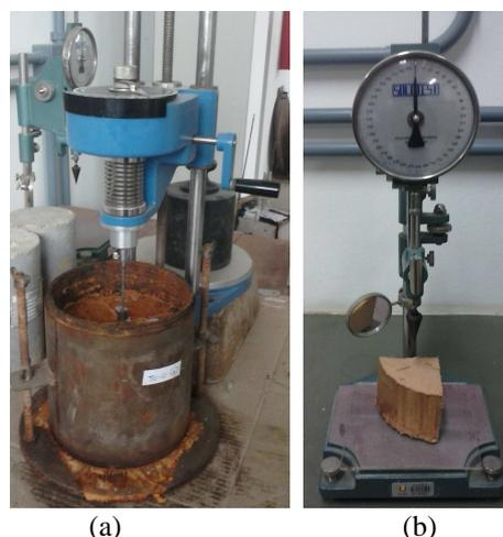
Figura 6. Ensaios de palheta (a) e cone (b)
