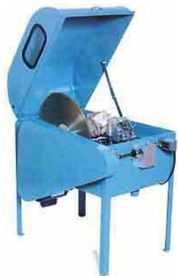
Figura 7 - Serra automática Lortone com diferenciais de operação (Fonte: www.lortone.com )
