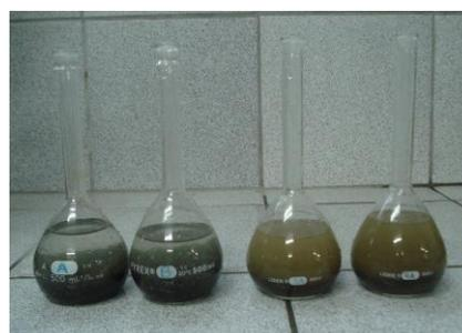
Figura 3. Picnômetros com o agregado e água destilada. Picnômetros da esquerda sem fíler e picnômetros da direita com fíler.
