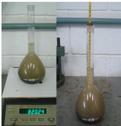
Figura 5. Processo de pesagem do picnômetro após a retirada do ar e verificação da temperatura da amostra.
