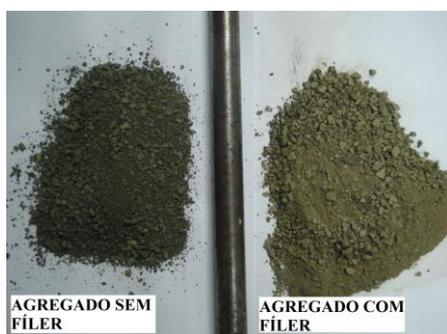
Figura 1. Amostra de agregado com e sem material fino (fíler).
