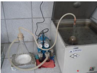
Figura 4. Picnômetro no banho-maria a 60 °C para retirada do ar com bomba de vácuo.
