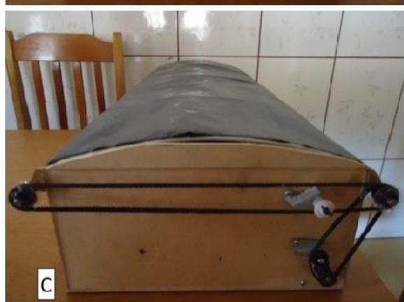
Figura 4. Enlonamento do modelo reduzido, começando (A), em processo (B) e enlonado (C).
