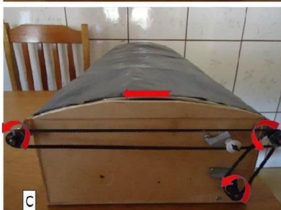
Figura 5. Desenlonamento do modelo reduzido, começando (C), em processo (B) e desenlonado (A).
