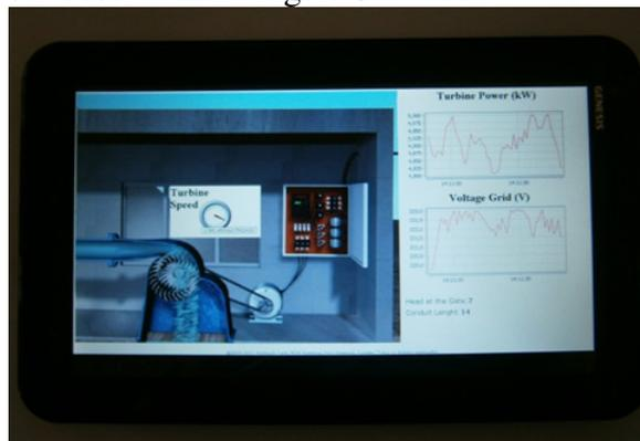
Figura 3. Sistema supervisorio acessado remotamente por um dispositivo móvel.
